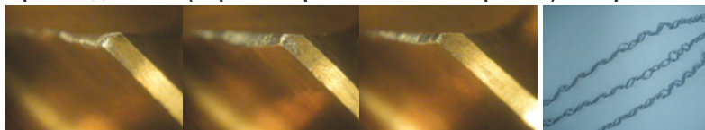
Производитель А (Нарезание резьбы в 330 отверстиях) - Спираль
