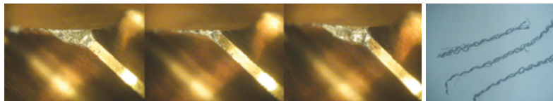
YG-1 (Нарезание резьбы в 490 отверстиях) - Спираль
