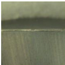
Фреза компании YG-1 (Общая длина фрезерования: 540 м)
