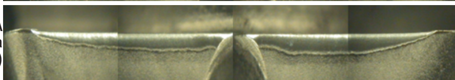
Фреза производителя А (Общая длина фрезерования 80 м)
